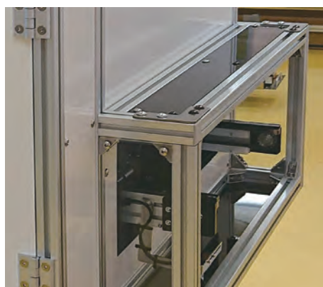
コンベア張り出し部カバー装着 コーティングへの異物付着防止に有効
